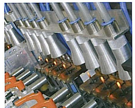
Fabrico de velas de incandescência em Ludwigsburg com comprovação de qualidade a 100%.
